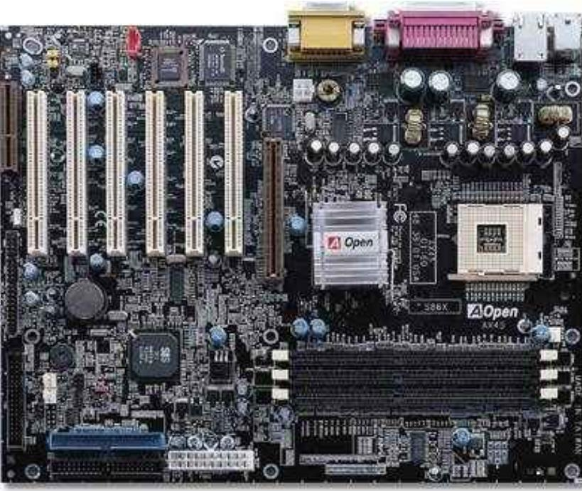
标准ATX主板的尺寸通常“横长竖短”，俗称“大板”，主要特点是将串口、并口、鼠标和键盘接口都固定在主板上，内置声卡功能时还将声卡的接口也一并做在主板上。另外ATX主板必须使用ATX结构的机箱电源，这样才能保证ATX主板的定时开机、Modem唤醒、键盘开机等特殊功能的实现。
