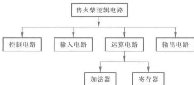
图 6.4.37 例 6.4.7 电路的模块划分
