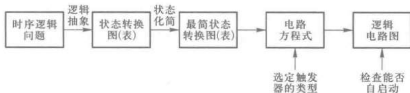
图 6.4.1 同步时序逻辑电路的设计过程
