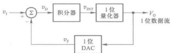
图 8.6.11 \Sigma - \Delta 型 A/D 转换器的方块图
