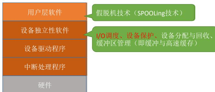
注：假脱机技术（SPOOLing 技术）需要请求“磁盘设备”的设备独立性软件的服务，因此一般来说假脱机技术是在用户层软件实现的。但是408大纲又将假脱机技术归为“I/O核心子系统”的功能，因此考试时还是以大纲为准。
