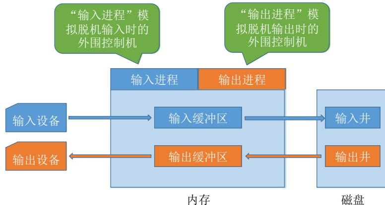
要实现SPOOLing 技术，**必须要有多道程序技术的支持**。系统会建立“输入进程”和“输出进程”。
