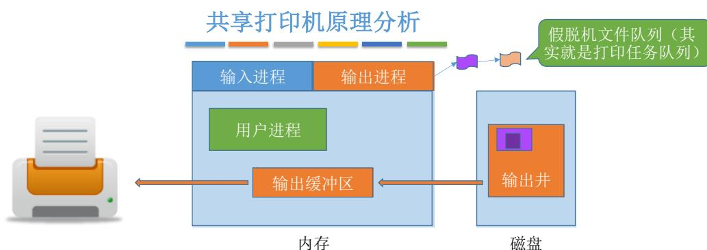
虽然系统中只有一个台打印机，但每个进程提出打印请求时，系统都会为在输出井中为其分配一个存储区（相当于分配了一个逻辑设备），使每个用户进程都觉得自己在独占一台打印机，从而实现对打印机的共享。
