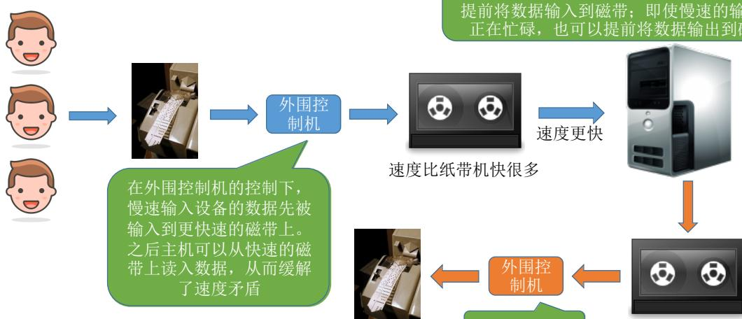
**Tips:** 为什么称为“脱机”——脱离主机的控制进行的输入/输出操作。
