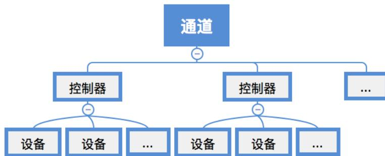
一个通道可控制多个设备控制器，每个设备控制器可控制多个设备。
