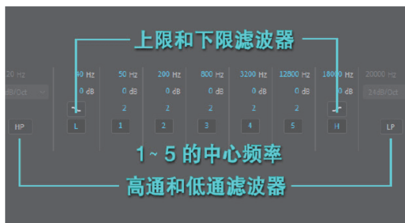
图4-2-28 高通、低通和限值滤波器
