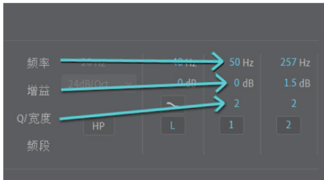
图4-2-27 参数均衡器修改频率和增益
